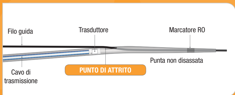
Struttura della punta del catetere IVUS standard
