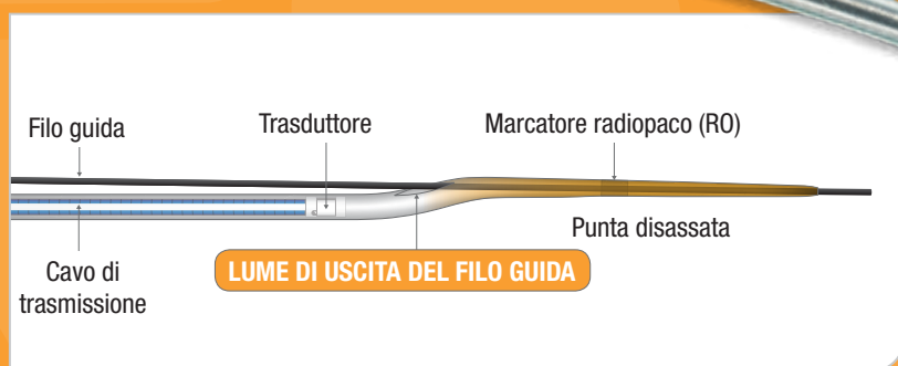
Struttura della punta disassata Kodama
